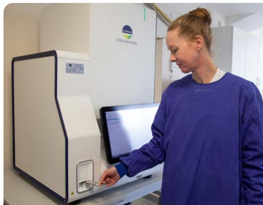
Target wird ins Massenspektrometer eingeladen Das getrocknete Target wird in den Massenspektrometer eingeladen. Die Probe wird dann mit einem Laser beschossen, ionisiert, beschleunigt und driftet durch das evakuierte Flugrohr. Ein Detektor erstellt ein Spektrum, das dann mit Referenzspektren von bekannten Keimen in der Datenbank abgeglichen wird.
